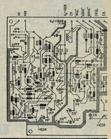
дают в цепь модулятора кинескопа. Цепь эта также не нужна при работе в режиме с двумя градациями яркости. Импульсы через диод VD10 поступают на парафазный предвыходной каскал (VT5). Интегрирующая цепочка на R26-R32, C22, C23 формирует пилообразное напряжение, управляющее выходным двухтактным каскадом на VT6, VT7. Нагрузкой последнего служит кадровая катушка (КК) отклоняющей системы (ОС) кинескопа. Последова-
