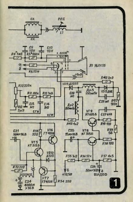
дации яркости (черно-белос), от нее можно отказаться. Собственно нагрузкой трансформатора Т2 является обмотка строчной отклоняющей системы (СК), включенная последовательно с регулятором линейности строк (РЛС) L1, и конденсатором С4. Диод VD1 демпферный, а конденсаторы С2, С3 обеспечивают резонансный режим работы транзистора VT1 и трансформатора Т2.
